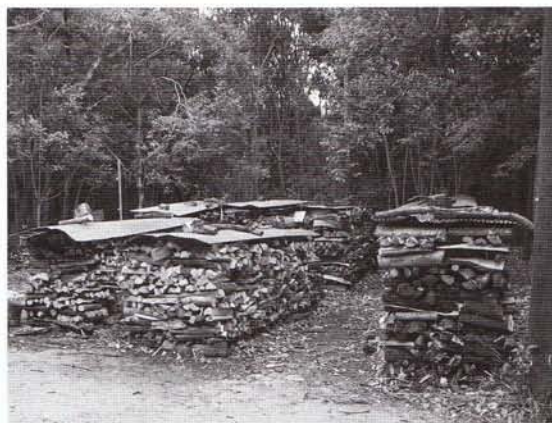
システムで利用する薪。半年以上乾燥させて使用している
