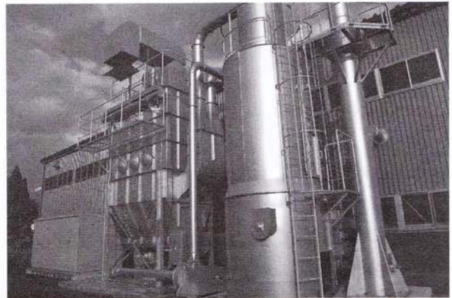
乾燥チップは冷却されると同時に屋外のサイロで一時的保管
