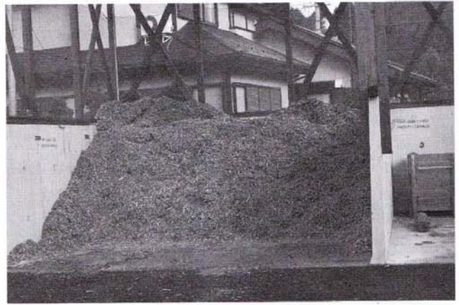
チップパーで破碎された間伐材のチップ
