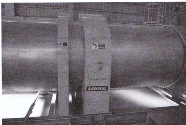
チップは細かく二次破碎されこのドラムで乾燥される
